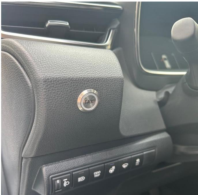
Das Dachzeichen wird über den beleuchteten Schalter unterhalb der linken Lüftungsdüse ein- und ausgeschaltet, sowie automatisch durch den Taxameter, welcher bei „Frei“ das Dachzeichen einschaltet und bei „Besetzt“ automatisch aus.
