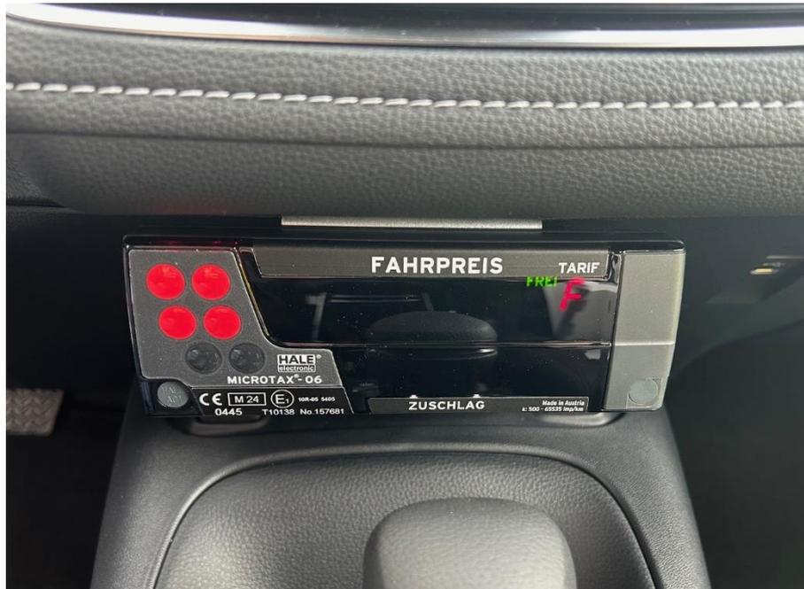
Der Taxameter/Wegstreckenzähler ist oberhalb der Mittelkonsole an der Unterseite des Armaturenbretts befestigt.
